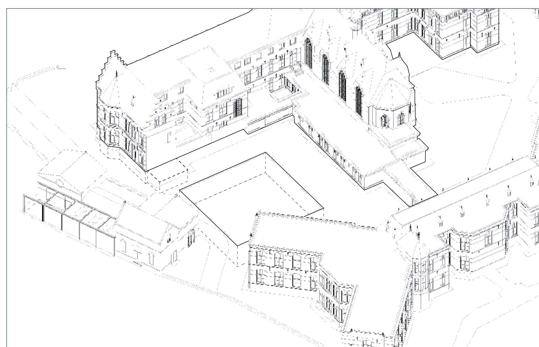
Bestaande toestand na sloop niet-historische aanbouwen en kelderdek
